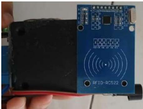
**Gambar 5.** Rangkaian Modul RFID RC522
